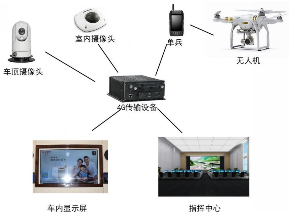
车顶高清摄像头，车内半球摄像头，单兵和无人机拍摄取证画面均可在车内大屏上显示，另也可通过 4G 设备实施传输到指挥中心，便于指挥调度；单兵设备可实现移动同步同录，办公过程中拍摄画面可直接传输到指挥中心。
